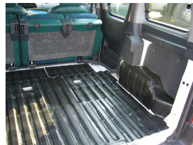
Wytłumiona matami podłoga i błotniki.
