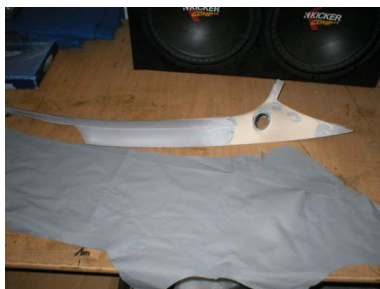
Słupek po zeszlifowaniu szpachli, podczas przymiarki materiału.
