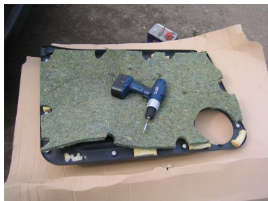
Tapicerka drzwi podczas dopasowywania wytłumienia z porosa.
