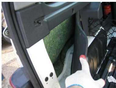
Wypełnianie pustych przestrzeni za tapicerkami tkaniną.
