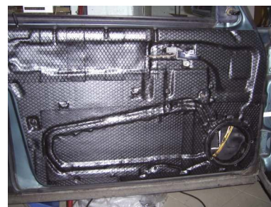
Dobrze wytłumione drzwi, z zamkniętymi otworami montażowymi.
