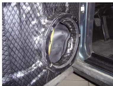
Pierścień dystansowy po wytłumieniu tylnej ścianki oraz całego przodu matami.
