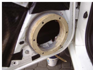
Pierścienie dystansowe z MDF przykręcone do drzwi i uszczelnione.
